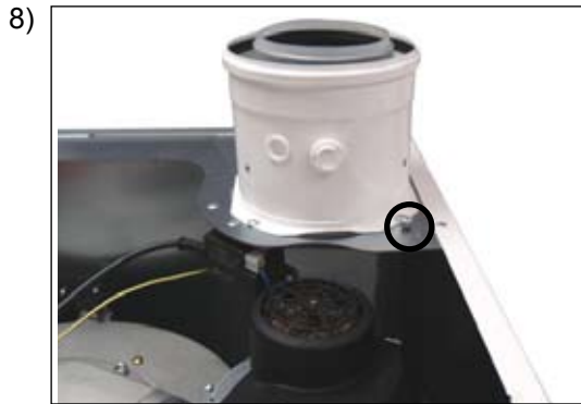
8) Dopo aver tolto il mantello superiore, svitare la vite di arresto del tubo aria/fumi.
