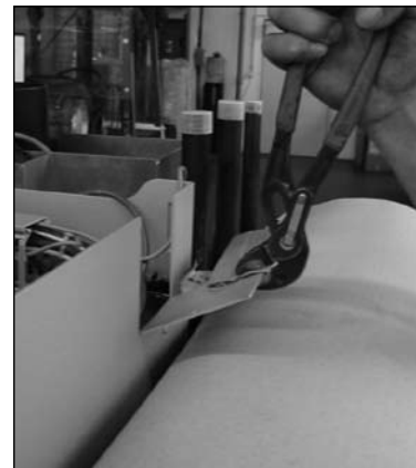
Abb. 41 Lasche nach AUSSEN biegen
