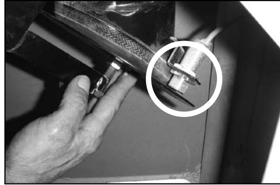
Abb. 28 Durch leichtes Andrücken, Klappe schließen. Abstand Klappe-Sensor : 2-3 mm
