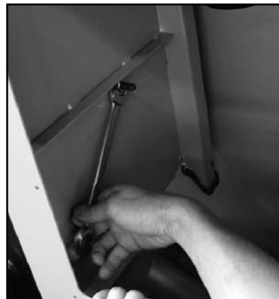
Abb. 26 Verbindungsschraube im Vorratsbehälter (Verb. Kessel mit Behälter)
