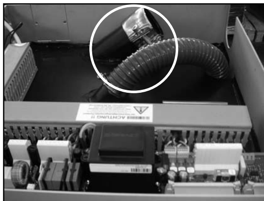
Abb. 05 Spannbride in montiertem Zustand mit Erdung (durch die sich im Förderschlauch befindende Erdungslitze).
