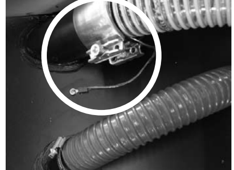
Abb. 44 Spannbride in montiertem Zustand mit Erdung (durch die sich im Förder- schlauch befindende Kupferlitze).
