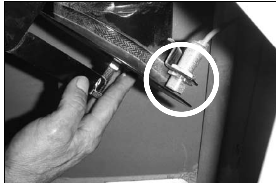
Abb. 29 Durch leichtes Andrücken, Klappe schließen. Abstand Klappe-Sensor : 2-3 mm
