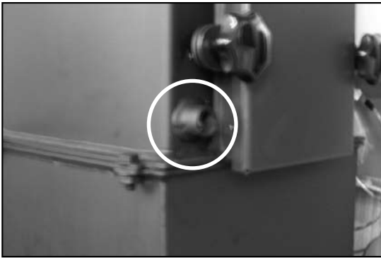
Abb. 08: Befüll- / Entleeranschluss BPH10, Anschluss 1/2 Zoll für KFE Hahn
